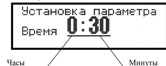
Рисунок 6 – Вид дисплея в состоянии задания времени нагрева
